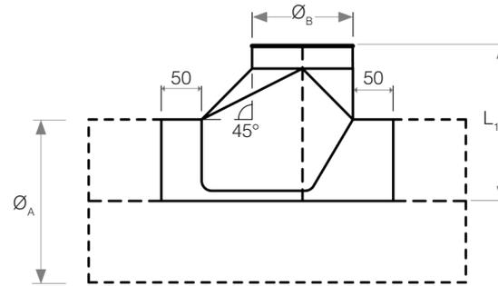
$$L = (\varnothing_A / 2) + (\varnothing_B / 2 + 58 \text{ mm})$$
